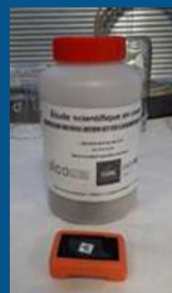
Figure 3 : Traqueur GPS inséré dans une bouteille en plastique
