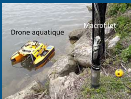
Figure 2 : Drone aquatique utilisé pour prélever les déchets dans les eaux de surface
